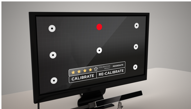
Figura 2.1: Calibración del rastreador ocular con nueve puntos (The Eye Tribe, 2017).
