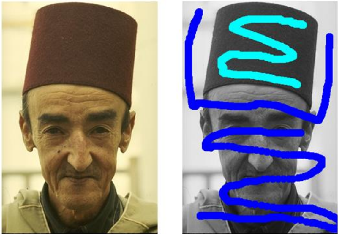
Figura 2.1: Ejemplo de un trimapa donde se señala el objeto de interés que en este caso es el sombrero y el resto de la imagen
