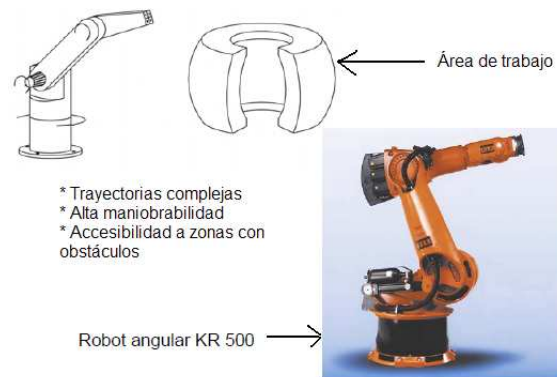
Figura 2.13: Robot antropomórfico o angular
