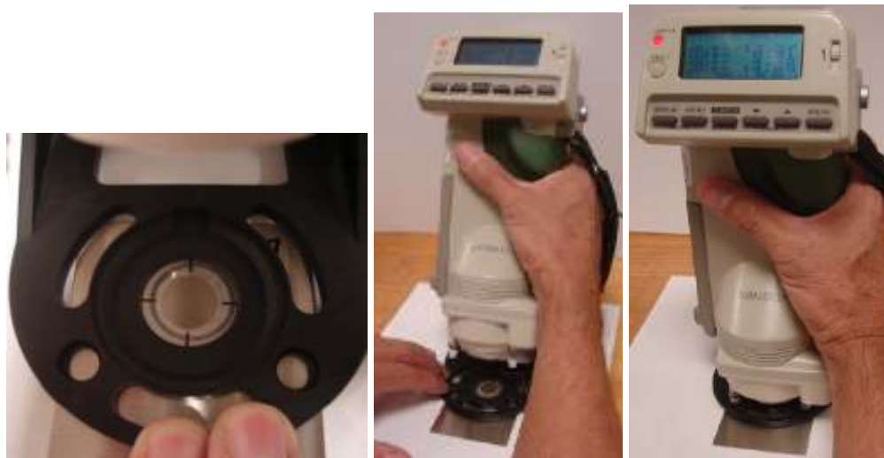
Fig. 2.11 Centrado y alineación de espectrofotómetro a probeta y medición
