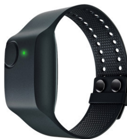
Figura 2: Pulsera empática e4, con sensor fotopletoislografo, sensor para actividad electro-dérmica, termómetro infrarojo y acelerómetro de 3 ejes.
