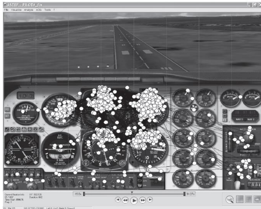
Figura 9 Entropía de las fijaciones en el estudio de Camilli. Visualización de la distribución o entropía de las fijaciones registrada durante una simulación de vuelo.
