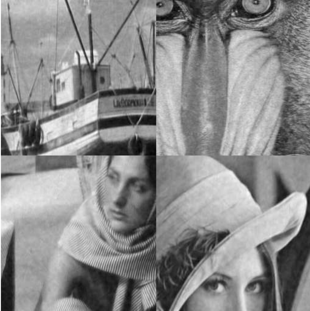
Figura 5.11: Detalles de filtrado usando el método CM-TH con k = 1 de las imágenes “boats”, “baboon”, “Barbara” y “Lena”, contaminadas con ruido gaussiano con \sigma_n = 20 .
