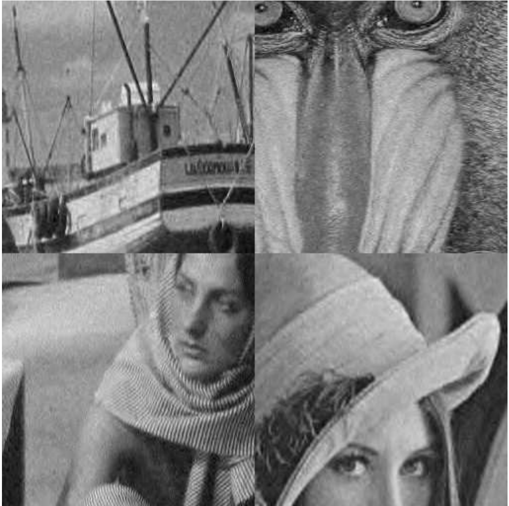
Figura 3.11: Detalles de filtrado BayesShrink de las imágenes “boats”, “baboon”, “barbara” y “lena”, contaminadas con ruido gaussiano con \sigma_n = 20 .
