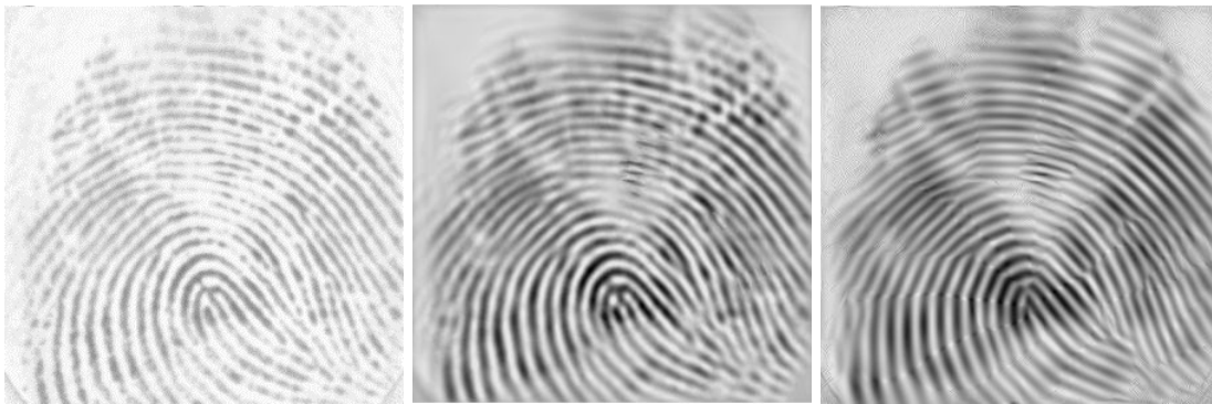
Figura 4.37: Resultados obtenidos para la imagen de prueba 1 utilizando el CCF de la Figura 4.36. Izquierda: Imagen original. Centro: Resultado Algoritmo 3. Derecha: Resultado Algoritmo 10.
