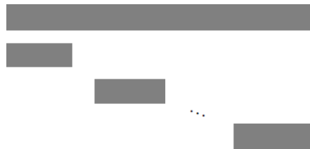
Figura 2: Patrón de un problema de programación lineal multi-divisional
