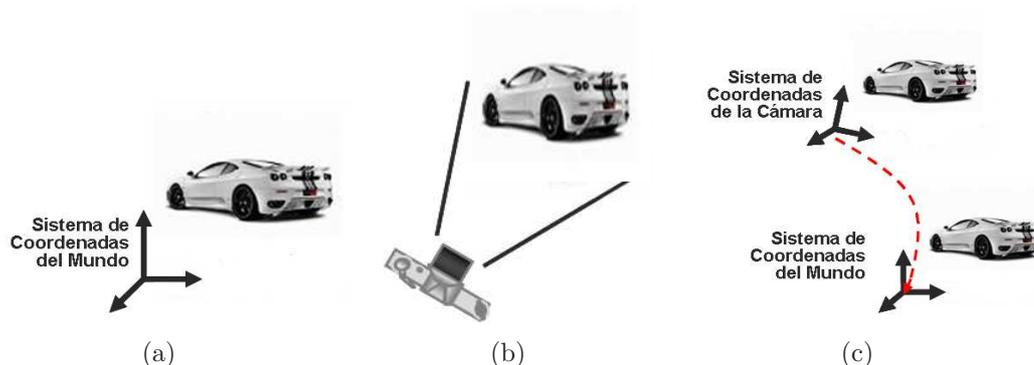
Figura 3.1: Posición y orientación de una cámara en relación a un objeto en el espacio. Dado un determinado objeto en el sistema de coordenadas del mundo, Fig. (a), se obtiene una imagen mediante una cámara, la cual maneja un sistema de coordenadas diferente, Fig. (b). El objetivo es estimar el movimiento de rotación y translación que alinee ambos sistemas de coordenadas, Fig. (c).
