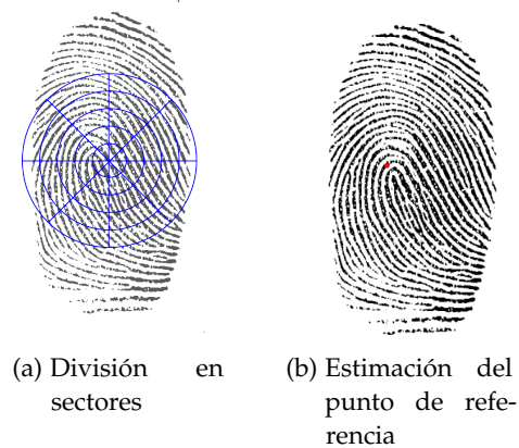
Figura 2.2.1: Localización del punto de referencia de la imagen de una huella dactilar para determinar su punto de referencia.
