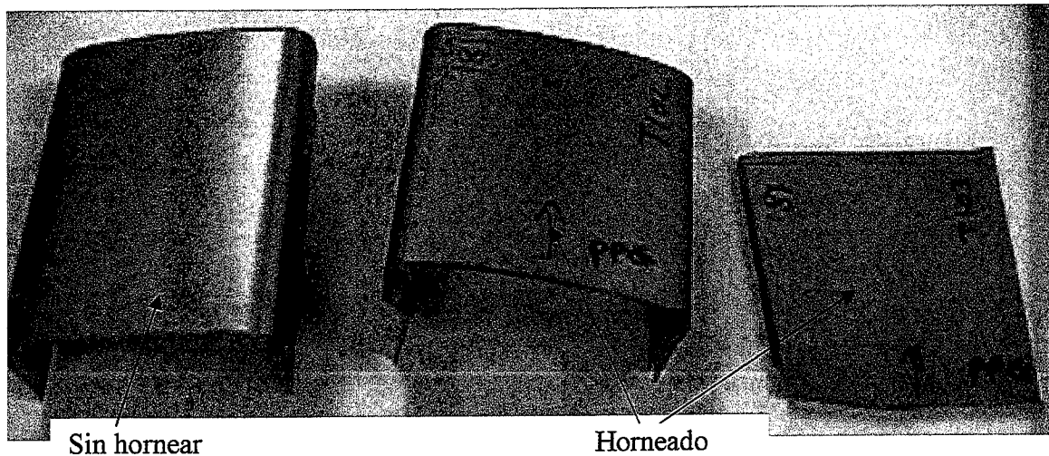
Fig. 2. Piezas con barniz sin hornear y horneadas (con cambio de color)
