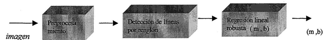
Figura 3-2: Diagrama del algoritmo de detección de líneas
